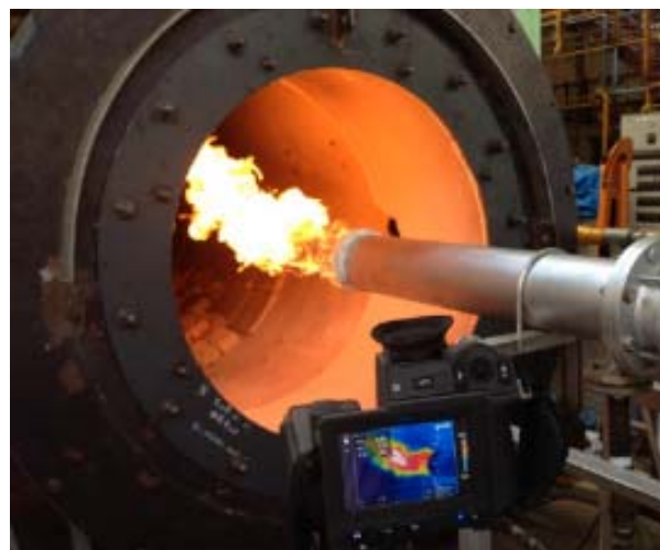
キルンバーナによる火炎パターン変化試験
