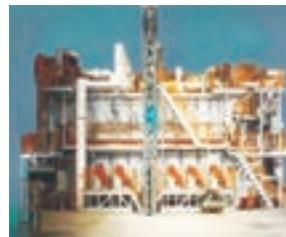
2階建AL鋳物T6熱処理炉
