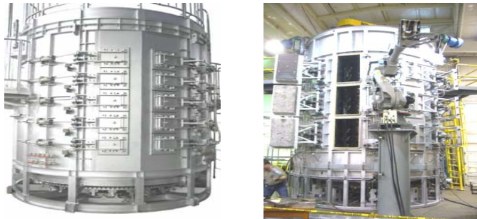
2階建AL鋳物T6熱処理炉
