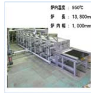
高張力鋼板連続加熱炉
