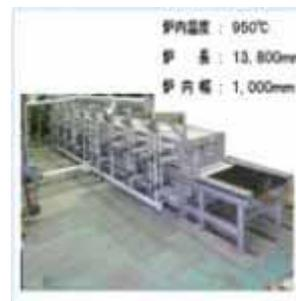
バッチ式熱処理炉(直火式)
