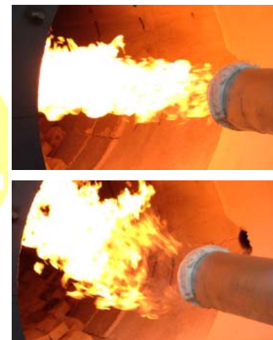
1次空気流量調整による火炎パターン変化
